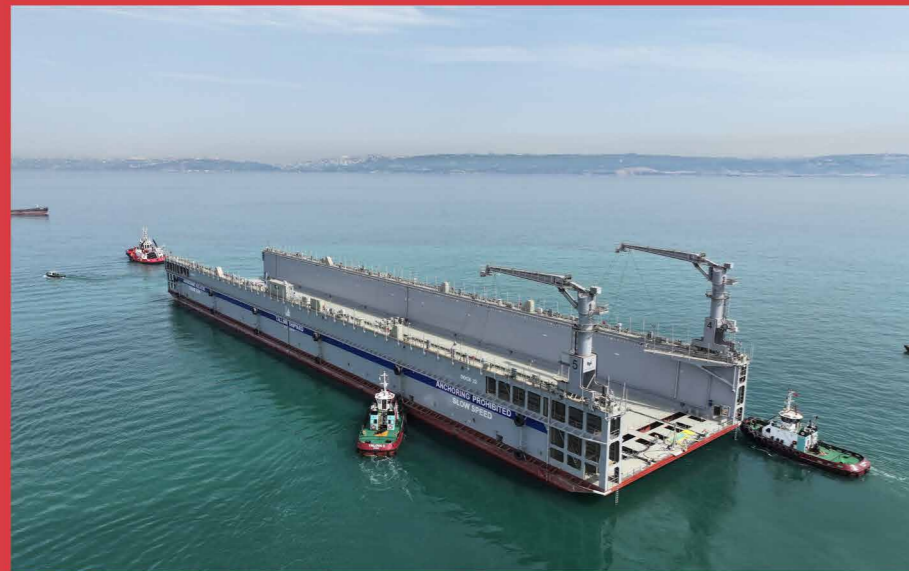
NB22 BLRT DOCK 10.000 TLC - 180 x 30 m
